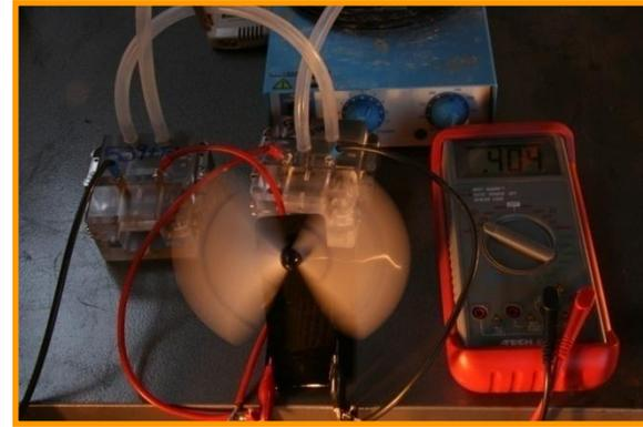
L'H<sub>2</sub> prodotto ha alimentato una cella a combustibile PEMFC (che ha prodotto energia elettrica con una densità di potenza massima di circa **60 mW/cm<sup>2</sup>** a temperatura ambiente).
